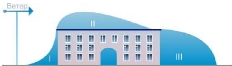
Рис. 10.10. Застойные ветровые зоны воздуха около промышленных зданий (по Г. В. Стадницкому и А. И. Родионову, 1996): I, II, III - «ветровые тени»
